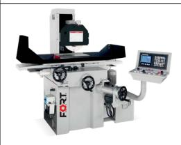
ускоренное перемещение вверх/вниз, минимальное приращение по оси «Z» 0,001 мм, возможность работы в автоматическом цикле
